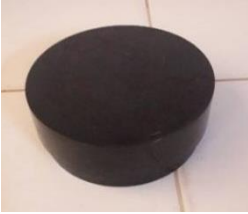
a) Porte-échantillon de 200 cm 3 pour le profilage
