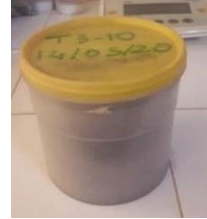
b) Porte-échantillon Marinelli 1L pour la mesure globale
