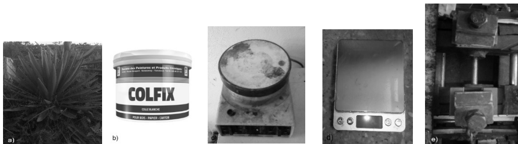
Figure 1 : Matériels utilisés : a) feuilles de sisal, b) colle vinylique, c) agitateur magnétique Heidolph MR2020, d) balance de précision, e) machine de micro-traction.
