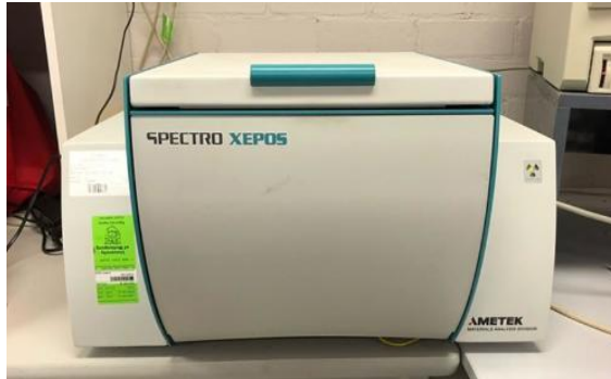
Figure 6 : Spectromètre de fluorescence des rayons X – SPECTRO XEPOS by AMETEK [W4]
