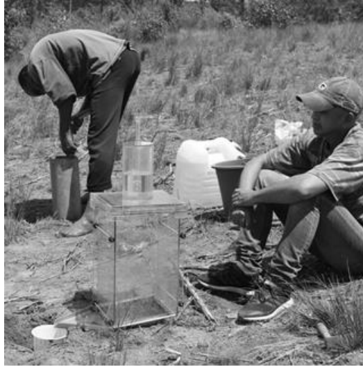
Figure 2 : Mesures directes de l'érosion à l'aide d'un simulateur portatif, (marque Eijkelkamp) et de la perméabilité du sol avec un infiltromètre
