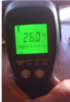
**Figure 5 :** Thermomètre infrarouge
