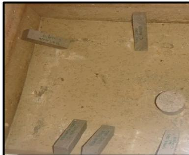
**Figure 7 :** Conservation des éprouvettes
