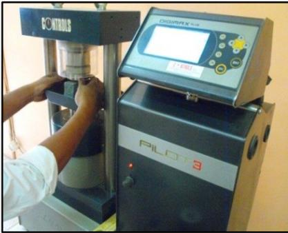
**Figure 8 :** Mesure de la résistance à la compression
