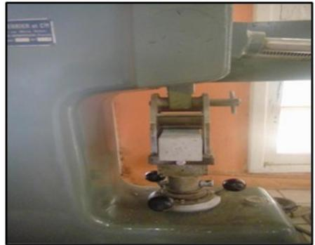
**Figure 9:** Mesure de la résistance à la flexion
