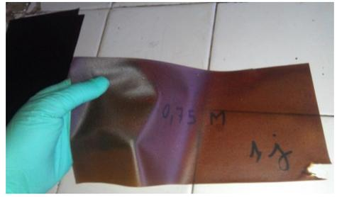
**Figure 13** : Résultat avec 0,75M HCl, 0,75M NaOH
